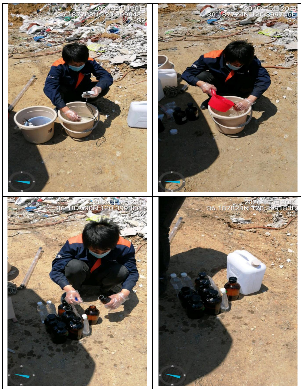
图 5.3-4 地下水洗井和采样照片
